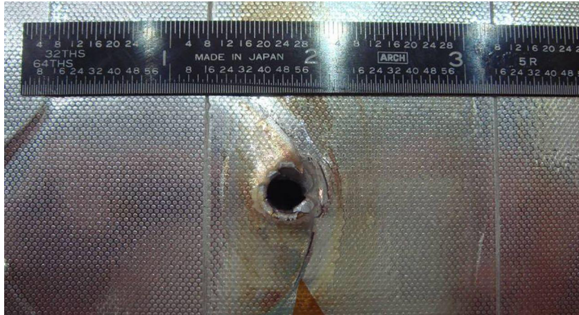
図 4 スペースデブリが衝突した宇宙物体 60
